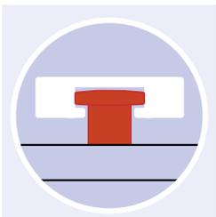
Der Sicherheitsverriegelungspunkt besteht aus einem flügelseitigen Sicherheitspilkopf, verkrallt in einem rahmenseitigen Sicherheitsschließblech.
